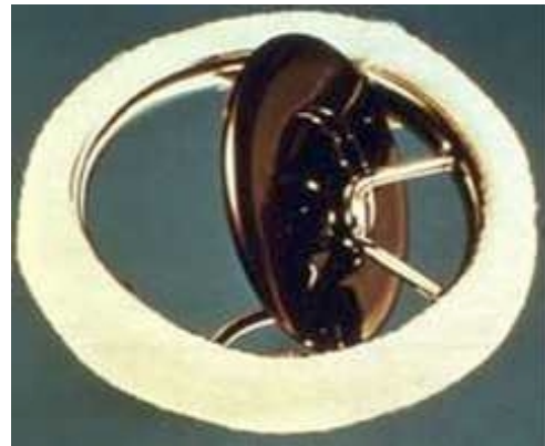
Figura 7 Válvula de Bjork-Shiley. El puntal de entrada era integral a la cubierta, mientras que el puntal de salida estaba soldado a la jaula, esta unión falló dando por resultado el escape de la valva.
